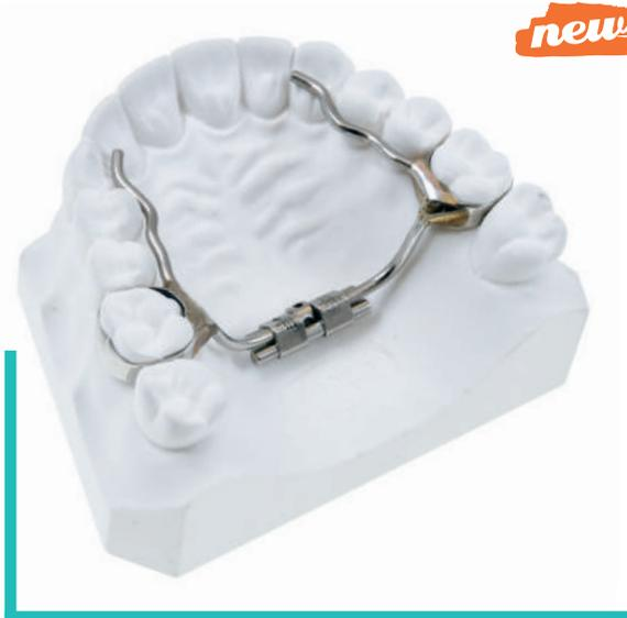
El expansor A1621 "Easy Access" se diferencia del modelo A0621 ya que, una vez posicionado en el aparato, el cuerpo del tornillo estará más cerca del paladar para que ocupe menos espacio y la cabeza del tornillo con los agujeros de activación será posicionada anteriormente respecto a la guía, por lo tanto, de fácil acceso para la activación con la llave.
