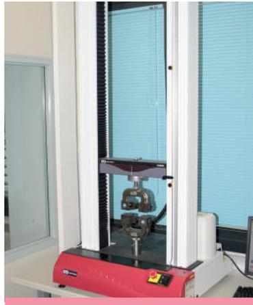
*El microdurómetro Shimadzu y la máquina de prueba Instron, en nuestro Centro Bio-Investigaciones Marco Pozzi, utilizados para el control de las características mecánicas de los alambres.*
