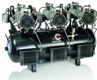
Compresor de 3 cabezas de 6 cilindros con seis secadores de aire, para 25 equipos. Dispone de las siguientes características: 3 motores trifásicos de 400V 50Hz independientes, una potencia total de 9.75 kW - 22.6 A, un depósito de aire de 300 litros, caudal efectivo a 5 bar de 1428 l/min y un nivel sonoro de 82.5 dB (A).
