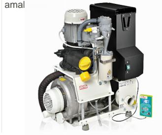
Alcanza 280mbar de presión de vacío con un motor Uni-Jet 75 2V de dos ventolas en serie y separador de amalgama. La presión elevada permite aspirar por tuberías de diámetro reducido, con una presión normal (170-200mbar) sería insuficiente. Potencia rendida: 1,5 kW - 9 A. Caudal máximo: 1.800 l/min.
