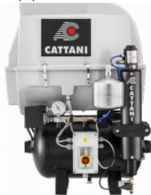
Compresor de 2 cilindros con secador de aire e insonorizado, para 2/3 equipos. Dispone de las siguientes características: Motor monofásico de 230V 50 Hz, potencia 1,2 kW - 7.7 A, depósito de aire con una capacidad de 30 l, caudal efectivo a 5 bar de 160 N l/min y un nivel sonoro de 63 dB (A).
