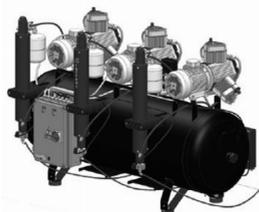
Compresor con 3 cabezas de 3 cilindros con tres secadores de aire, para 15 equipos. Dispone de las siguientes características: 3 motores trifásicos 400V 50Hz independientes, potencia total de 4.5 kW - 11.1 A, un depósito de aire de 300 litros, caudal efectivo a 5 bar de 714 l/min y su nivel sonoro es de 75 dB (A).
