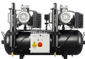
Compresor de 2 cabezas de 3 cilindros con dos secadores de aire, para 10 equipos. Dispone de las siguientes características: 2 motores trifásicos 400V 50Hz independientes, potencia total de 3 kW - 7.4 A, un depósito de aire de 150 litros, caudal efectivo a 5 bar de 476 l/min y su nivel sonoro es de 77 dB (A).
