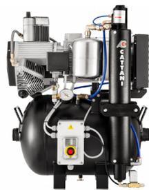
Compresor de 3 cilindros con secador de aire, para 4/5 equipos. Dispone de las siguientes características: Motor monofásico de 230V 50 Hz, potencia 1,5 kW - 10,2 A, depósito de aire con una capacidad de 45 l, un caudal efectivo a 5 bar de 238 l/min y un nivel sonoro de 73.6 dB (A).
