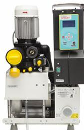
Aspiración progresiva, de 1 a 3 equipos en su versión A. Con su sistema inverter, reconoce en cada momento las necesidades de aspiración, adaptando la velocidad del motor en tiempo real. Con separador de amalgama ISO 18. Potencia rendida: 1.5 kW - 6.5 A. Caudal máximo: 1400 l/min (1800 l/min).
