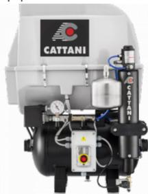
Compresor de 1 cilindro con secador de aire e insonorizado, para 1 equipo. Dispone de las siguientes características: motor monofásico de 230V 50 Hz, potencia de 0,55 kW - 3,8 A, un depósito de aire de 30 litros, un caudal efectivo a 5 bar de 67,5 N l/min, y su nivel sonoro es de 62 dB (A).
