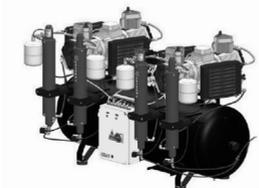
Compresor de 2 cabezas de 6 cilindros con cuatro secadores de aire, para 20 equipos. Dispone de las siguientes características: 2 motores trifásicos de 400V 50Hz independientes, una potencia total de 6.5 kW - 15 A, depósito de aire de 300 litros, un caudal efectivo a 5 bar de 952 l/min y un nivel sonoro de 81 dB (A).
