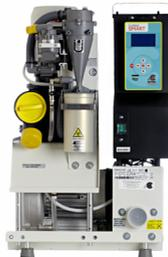
Aspiración progresiva, de 1 a 3 equipos en su versión A. Con su sistema inverter, reconoce en cada momento las necesidades de aspiración, adaptando la velocidad del motor en tiempo real. Con separador de amalgama ISO 18. Potencia rendida: 1.22 kW - 7 A. Caudal máximo: 1400 l/min (1700 l/min).
