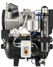
Compresor de 2 cilindros con secador de aire, para 2/3 equipos. Dispone de las siguientes características: Motor monofásico de 230V 50 Hz, potencia 1,2 kW - 7.7 A, depósito de aire con una capacidad de 30l, caudal efectivo a 5 bar de 160 l/min y un nivel sonoro de 71.8 dB (A).
