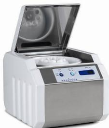
Separador de fases de sangre CGF, con capacidad de hasta 8 tubos y un soporte fácil de limpiar y esterilizable en autoclave a 135°. El sistema del rotor mantiene la temperatura constante. Contiene un kit muy completo con material e instrumental para crear membranas de fibrina entre otros protocolos.
