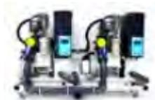
Potencia total: 4kW - 18A. Caudal máximo de aspiración: 3.400 l/min. Presión de trabajo: 280 mbar. En un sistema de aspiración Smart en paralelo, las máquinas trabajan juntas para todos los sillones, reconociéndose y regulando la velocidad según la carga de trabajo, si una falla la otra sigue.
