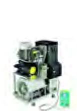
Aspiración progresiva, de 1 a 3 equipos en su versión A. Con su sistema inverter, reconoce en cada momento las necesidades de aspiración, adaptando la velocidad del motor en tiempo real. Con separador de amalgama ISO 18. Potencia rendida: 1.22 kW - 7 A. Caudal máximo: 1400 l/min (1700 l/min).
