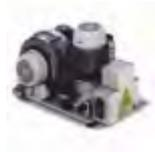
Aspiración con motor Uni-Jet 75 2V de doble ventola, de alto vacío. Aconsejada para equipo de cirugía o donde se necesite una aspiración potente. Potencia rendida: 0.80 KW - 6,1 A. Caudal máximo: 650 l / min. Presión máxima de trabajo en servicio continuo: 260 mbar. Nivel sonoro: 65 dB (A).
