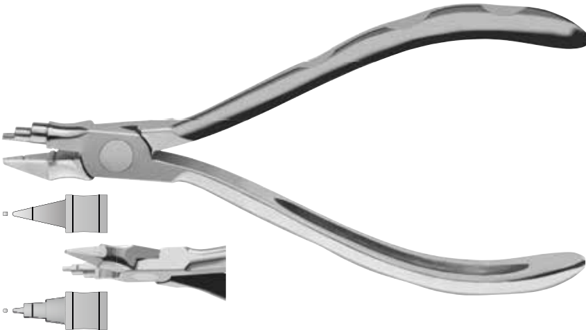
OLS-1329 YOUNG Universal Zange zum Biegen von Loops in beliebigen Abmessungen. Ideal für Labialbögen. Universal loop bending pliers for different size loops. Ideal for labial arches. Pince universelle pour former des loops dans diverses dimensions. Idéal pour les arcs labiaux Fórceps universales para torcer bucles en cualquier dimensión. Ideal para arcos labiales max. 0,028" / 0,7mm
